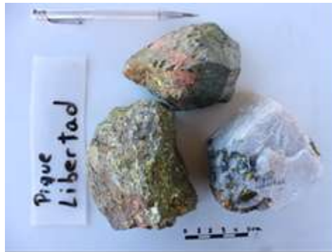
Figura 09.- Mineral en Veta Libertad, continuidad en Veta ExRuleta en Alinderamiento. El color blanco es calcita; el rosado es feldespato potásico, el amarillo metálico es calcopirita.
